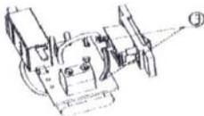
Verlöten Sie den Schalter und die Platine an den mit „3“ gekennzeichneten Stellen.
